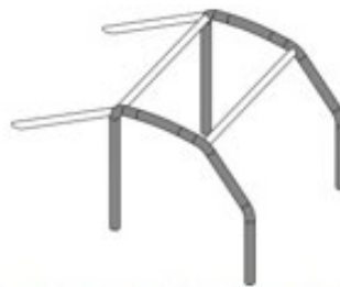
2 oldalsó bukócső / lateral rollbars 2 keresztmerevítő / transverse members
