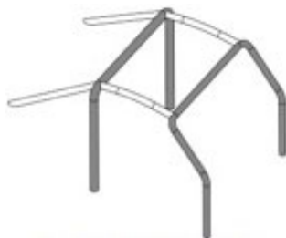
1 főbukócső / main rollbar 1 mellő bukócső / front rollbar
