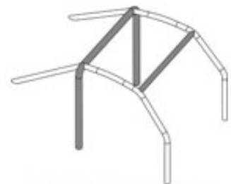
1 főbukócső / main rollbar 2 oldalsó félbukócső / lateral half-rollbars
